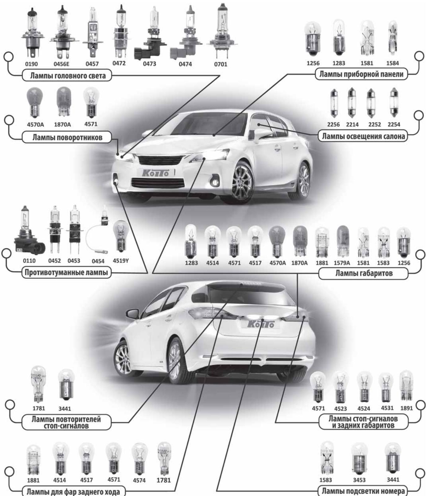
• Лампы панели приборов (Meter panel lamp)
