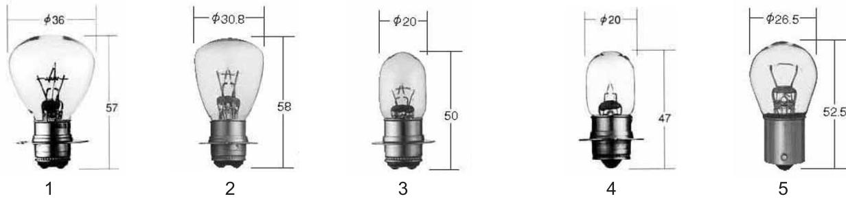
Лампы применяемые для фар мотоциклов - вспомогательное освещение
